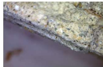
7a-e. Macrofoto eseguite con microscopio digitale portatile: a) biopatogeni; b) colore originale rosa carne con soprastante rasatura cementizia e tinta ocra acrilica; c, d) distacco della rasatura cementizia con tinta acrilica e fenomeni di delaminazione degli strati; e) rasatura cementizia su intonaco a calce. 8ab,c. Sequenza delle cromie individuate: rosa carne per gli sfondati e giallo paglierino per gli oggetti (cornici, lesene, elementi decorativi).
